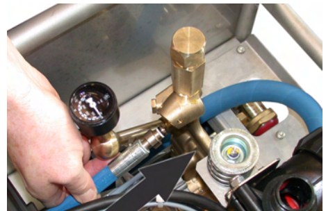
→ Verschlussstopfen herausnehmen, Dichtring fetten und den Verbindungsschlauch einschieben
