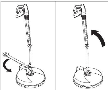
→ Prúdovú rúrkú vysokotlakového čistaceho prístroja pripojte na FR Classic a riadne utiahnite skrutkovacím kľúčom (veľkosť kľúča 24).
