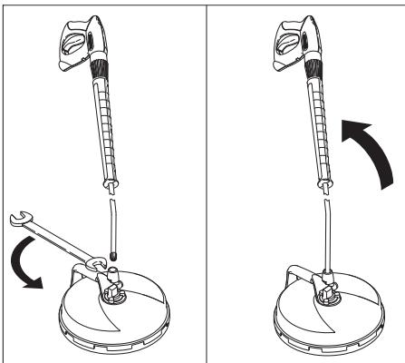
→ Yüksek basınçlı temizleyicinin püskürme borusunu FR Classic'e bağlayın ve civata anahtarıyla (anahtar genişliği 24) sıkın.
