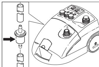
Použijete-li znečištěnou vodu, může dojít k ucpání filtru. To je patrné na základě obzvlášť dlouhých provozních dob čerpadla nebo na základě celkové nefunkčnosti přístroje.
