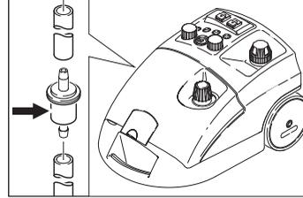
Temizlenmemiş su kullanılması durumunda filtre tıkanabilir. Bu durum, pompanın alışılmışın dışında uzun süreli alışması ya da komple fonksiyon kesintisinde kendini belli eder.
