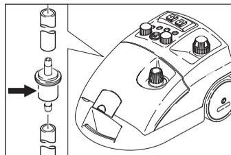
Hvis man bruger tilsmudset vand kan filteret tilstoppe. Det vises idet pumpen kører længe eller svigter.
