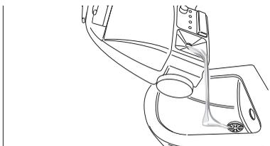
Rincer la chaudière du nettoyeur à vapeur après 5 remplissages de chaudière au maximum.
