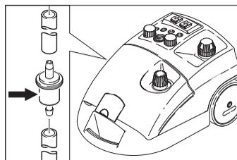
Prilikom primjene onečišćene vode filter se može začeptiti. To se može primijetiti u izvanredno dugim razdobljima rada pumpe ili u potpunom prekidu rada.
