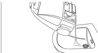
Spălați rezervorul cel târziu după fiecare a 5-a umplere.
