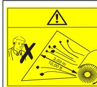
Опасность отбрасывания деталей при работающем подметающем вале. Держаться на безопасном расстоянии (3 м) от передней и боковых частей устройства
