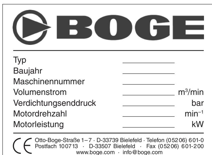
Abb. 1.1: Daten auf dem Typenschild
