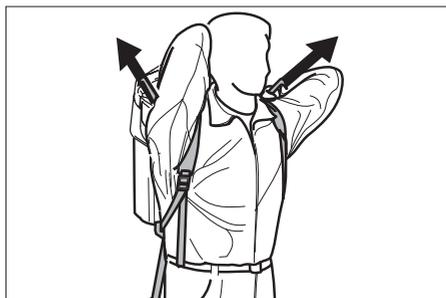
→ Positie van het apparaat op de rug door te trekken aan de eindspanner instellen.
