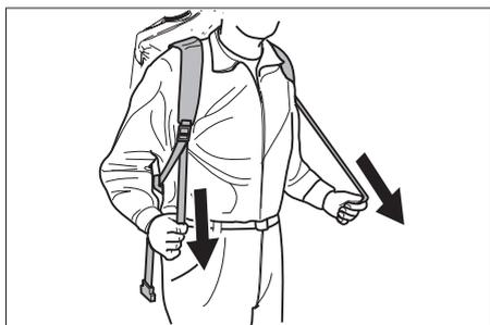
→ Zariadenie si na tele upravte potiahnutím za stredový napínač. Príliš nezaťažujte, lebo hlavná záťaž má spočívať na bedernom páse.
