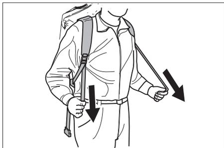
→ Tilpasse maskinen til kroppen ved at stramme stroppen i midten. Stroppen må ikke strammes for stærkt, hovedbelastningen skal være på hofteselen.
