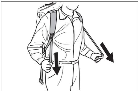
→ Gerät durch Ziehen an den Mittelstraffern an den Körper anpassen. Nicht zu stramm anziehen, die Hauptlast sollte auf dem Hüftgurt liegen.
