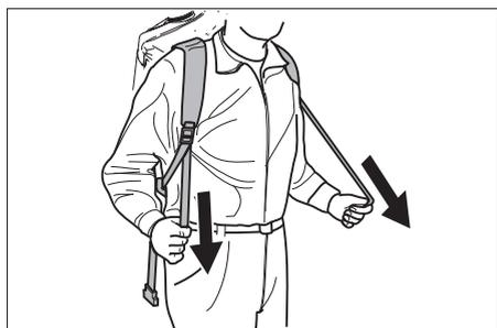
→ Polohu zařízení přizpůsobte tělu přitahováním středových napínáků. Nenapínejte příliš, hlavní zátěž by měla spočívat na bederním úvazu.
