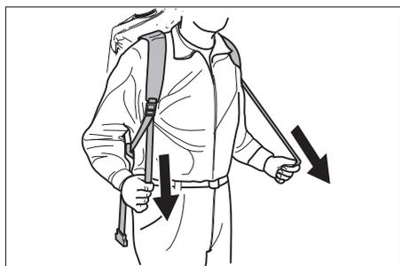
➔ Napravo z vlečenjem na srednjem napenjalniku prilagodite na telo. Na napnite preveč, glavna obremenitev naj bi bila na kolčnem pasu.
