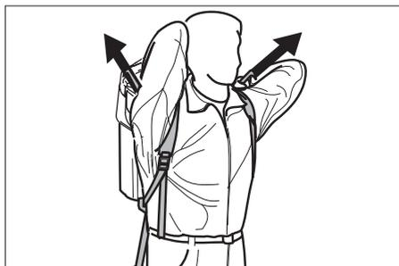
→ Polohu zařízení na zádech nastavíte přitahováním koncových napínáků.
