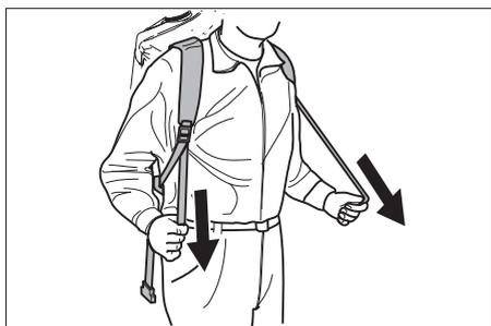
→ Het apparaat door te trekken aan de middenspanner aan het lichaam aanpassen. Niet te strak aantrekken, de hoofdlast moet op de heupgordel liggen.
