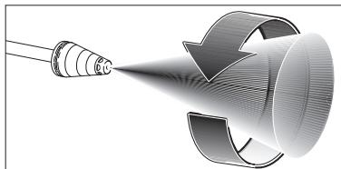
■ Avant de nettoyer une quelconque surface, procéder à un essai sur une petite surface discrète pour déterminer le mode d'action et la distance qui produiront les meilleurs résultats de nettoyage.
