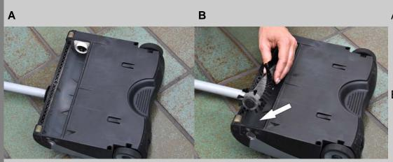
Umwickelte Haare entfernen Sie am besten mit Messer bzw. Schere, durch Entlangfahren an der vorgegebenen Schnittkante der Bürstenwalze. Gelöste Haare von der Bürstenwalze entfernen. Gereinigte bzw. neue Kehrwalze einsetzen und auf richtigen Sitz prüfen.
