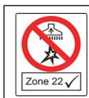
Tændingskilder må ikke op-suges! Eget til opsugning af brændbar støv af støveksplionsklassen i zone 22.
