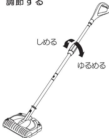
伸縮ハンドルは作業しやすい長さに調節できます。アジャスターを反時計回りに回してゆるめ、ハンドルを調節してください。調節が終わったらアジャスターを時計回りに回してしっかりしめてください。
