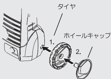
タイヤの中央部の穴を本体のタイヤ取り付け部の穴に合わせ、ホイールキャップで留めます。
