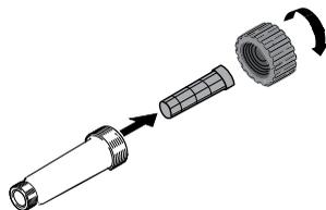
先端部をねじって取り外し、中に入っているフィルターを取り出してください。
