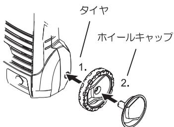
タイヤの中央部の穴を本体のタイヤ取り付け部の穴に合わせ、ホイールキャップで留めます。
