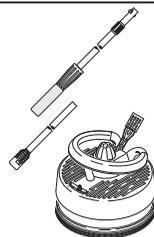
ノズル高さ調整機能により洗浄パワーを調整できます。
