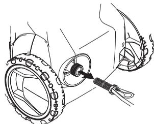
先端が平らなペンチなどで、給水口内部からフィルターを引き抜いてください。
