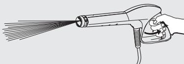
約 15～30 秒間ガンのレバーを握り水を出し続けるとホースの中の空気が抜け水圧が安定します。
