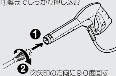
ノズルをトリガーガンに奥までしっかり押し込みながら矢印の方向に90度回してください。
