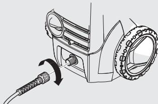
高圧ホース接続口へ高圧ホースをまっすぐに差し込み、ナットを手で締めてください。
