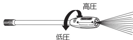
ノズルの先端を回すことにより低圧から高圧まで無段階に圧力を調整できます。(洗浄剤は最低圧時に噴射します。)
