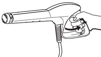
トリガーガンのレバーを握りポンプ内の残留圧力を抜き、レバーを放してください。
