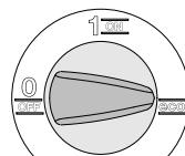
Laite käynnistetään käänämällä laitekytkin asentoon „1/ON“ tai „eco“.
