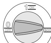
For å slå på maskinen brukes bryterstilling "1/ON" og "eco".
