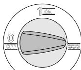
Чтобы включить устройство следует установить выключатель в положение „1/ON“ и „есо“.
