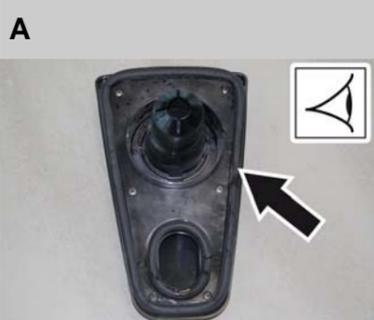
A Dichtungen zwischen Schmutzwassertank und Deckel reinigen und auf Dichtigkeit prüfen, bei Bedarf austauschen.
