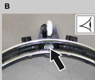
B Saugkanal reinigen.
