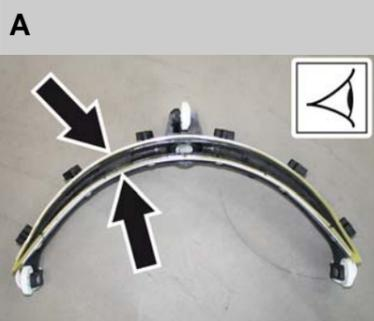
A Sauglippen am Saugbalken reinigen, bei Bedarf wenden oder austauschen.
