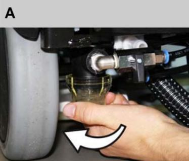
A Filter Frischwasser reinigen.
