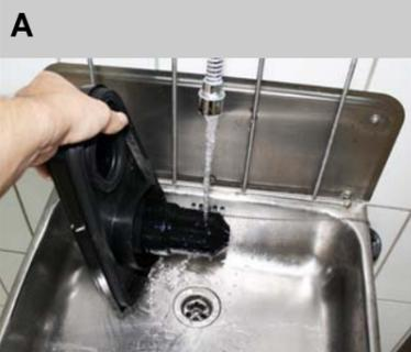
A Deckel des Schmutzwassertanks abnehmen und Deckelinnenseite und Schwimmer mit Wasser abspülen.
