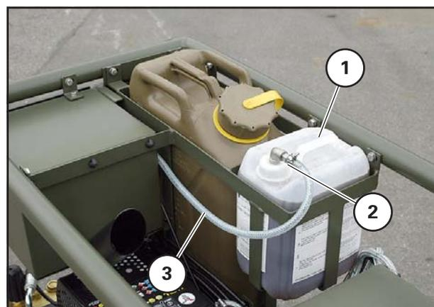
Bild 25 Kanister Kalkstabilisator
