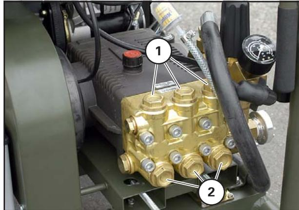
Bild 74 Ventile Wasserpumpe
