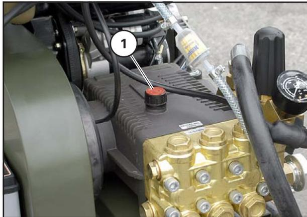
Bild 70 Öleinfüllöffnung Wasserpumpe
