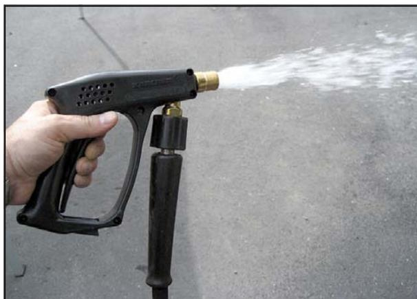
Bild 19 Wasserstrahl an Handspritzpistole ohne Strahlrohr
