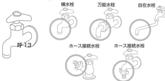
内径 15mm の水道ホースが確実に取り付けられる丸蛇口でお使いいただけます。水道ホースを蛇口に差し込み、付属のホースバンドで固定します。
