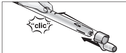
Фиг. 4: Поставяне на куката за паркиране
