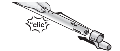
Abb. 4: Τοποθέτηση του άγκιστρου στάθμευσης
