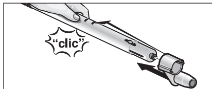
Fig. 4 : emboîtement du dispositif de parage
