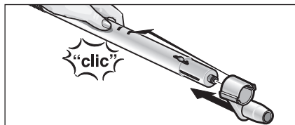
Fig. 4: Påsætning af låsekrogen
