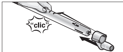
Рис. 4 Присоединение паркового крюка
