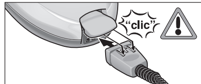
Рис. 1: фіксація блочного штекера
