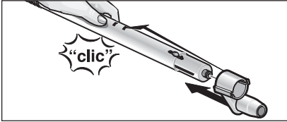
Рис. 4: приєднання паркового гака
