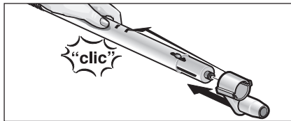
4. ábra: Parkolókampó felszerelése
