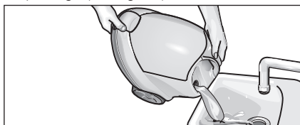
Fig. 12 : rinçage de la chaudière
