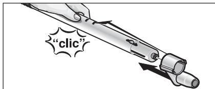
Fig. 4: Sette på festekroken
