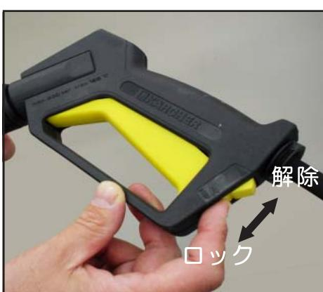
トリガーガンのレバーを握りポンプ内部の残圧を抜いてください。
