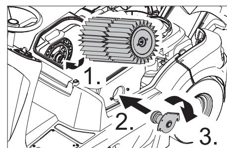
→ Verifique que el arrastrador encaje en orificios (lado de accionamiento).
