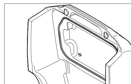
→ Sous le capot, extraire le joint d'étanchéité du boîtier de la rainure.
