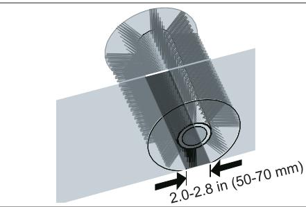
La superficie de barrido forma un rectángulo regular, que tiene entre 2.0 y 2.8 in (50 y 70 mm) de ancho.
