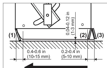
→ Orienter la baguette d'étanchéité.
