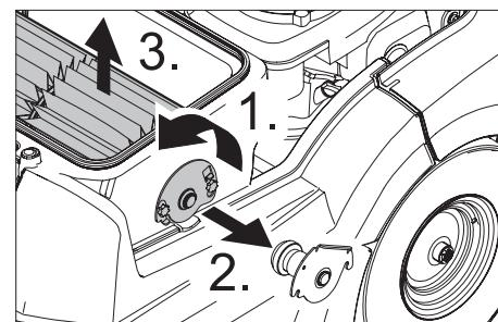
→ Suelte los tornillos de fijación.
