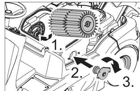
→ Enclencher l'entraîneur dans les rainures du côté de l'entraînement.
