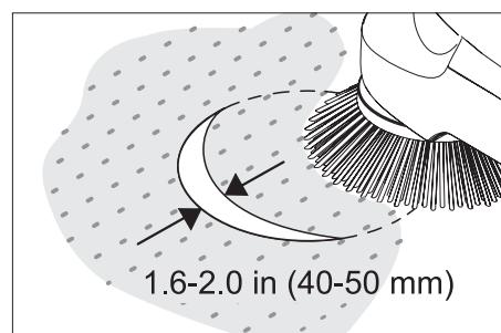
La largeur de la trace de balayage doit être entre 1.6 et 2.0 in (40 et 50 mm).
