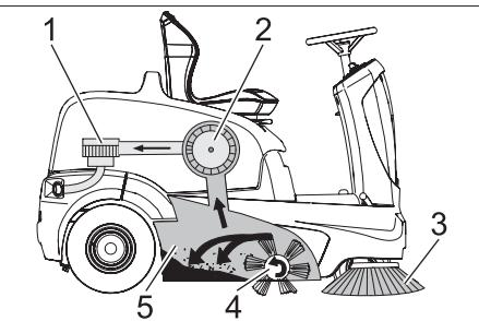
La balayeuse fonctionne selon le principe du balayage par soulèvement et projection.
