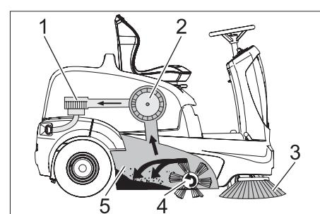
La escoba mecánica funciona según el principio de rosca.
