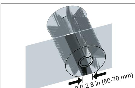
La trace de balayage doit former un rectangle régulier d'une largeur de 2.0 à 2.8 in (50 à 70 mm).
