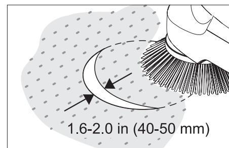
El ancho de la superficie de barro debe estar entre 1.6-2.0 in (40-50 mm).
