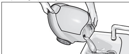
Fig. 12 : rinçage de la chaudière
