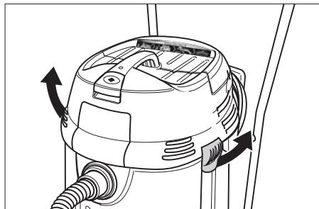
➔ Desbloquear y extraer el cabezal de aspiración.
