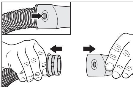
Le flexible d'aspiration est doté d'un système à clip. Il est possible de raccorder tous les accessoires C-40/C-DN-40.
