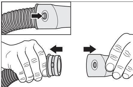
La manguera de aspiración está equipada con un sistema de clip. Se pueden conectar todos los accesorios C-40/C-DN-40.
