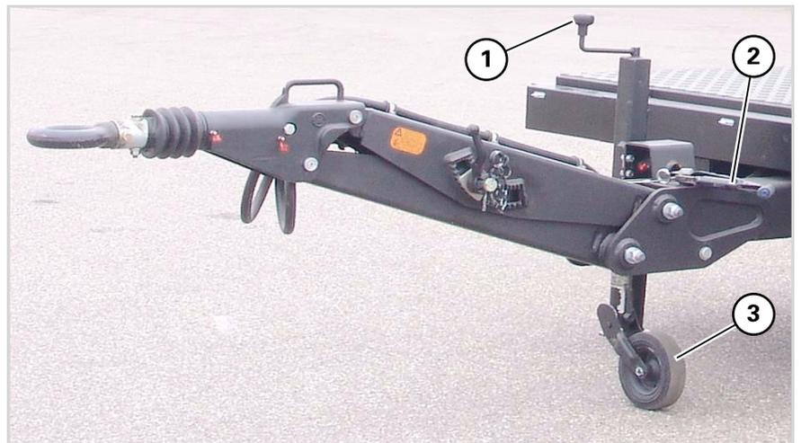
Bild 34 Stützrad und Handbremshebel
