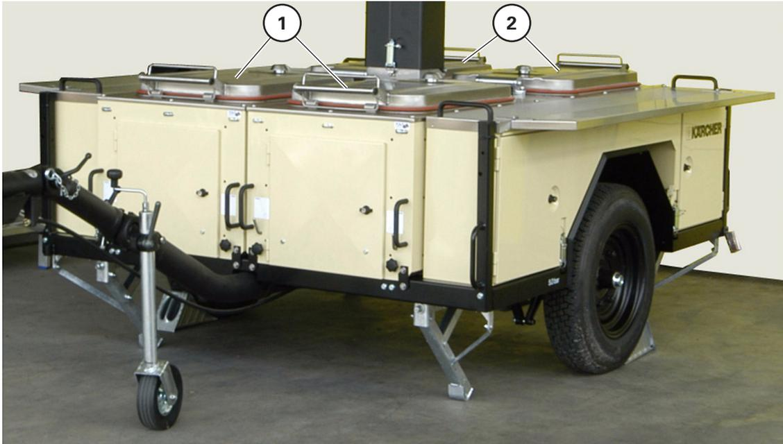
Bild 19 Kocheinrichtung, auf Anhänger verlastet
