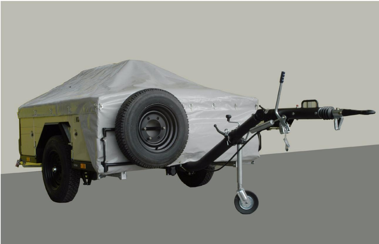
Bild 1 Anhänger Modulfeldküche fahrbereit, Ansicht von vorne/rechts
