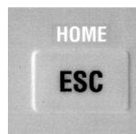
Pulsando la tecla «ESC» se accede al menú inmediatamente superior, no importando qué línea del menú se esté mostrando en la pantalla. Pulsando repetidamente la tecla "ESC" se llega así hasta el menú principal.
