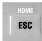
La touche «ESC» permet de revenir au menu immédiatement supérieur. La ligne actuellement lisible à l'afficheur ne joue ici aucun rôle. En réappuyant sur "ESC", on arrive jusqu'au menu principal.
