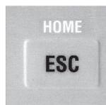
Mit der Taste „ESC“ gelangt man zurück zum nächst höheren Menü. Dabei ist es unwichtig, welche Zeile gerade im Display angezeigt wird. Durch wiederholtes Drücken von „ESC“ gelangt man so bis zum Hauptmenü.
