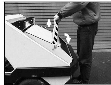
Soulèvement et fermeture du volet d'éjection de la cuve
