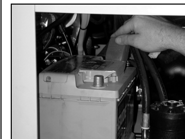
Klemmung für Pluspol-Leitung lösen
