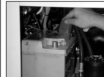
Desserrer la fixation de câble de pôle positif
