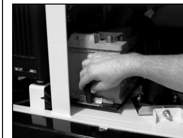
Accuhouder er afschroeven Accu aan de bevestigingslussen verwijderen
