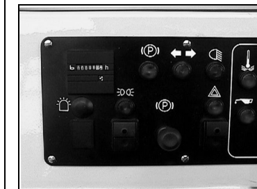
Driftstimetælleren angiver tidspunktet for serviceintervallerne
