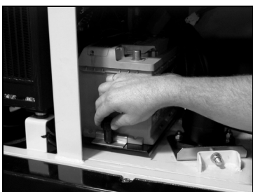
Skruva loss batterihållare Ta ut batteriet ur batterihållaren
