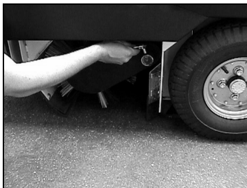
➤ Klappsplint durch die Bohrung stecken und die Ringfeder umklappen
