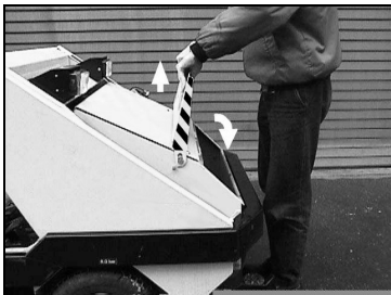
Nosta säiliön jäteluukku ja sulje se
