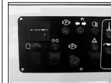
Driftstimetelleren angir tidspunktet for vedlikeholdsintervallene
