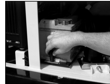
Ruuvaa akkupidikettä irti Irrota akku kiinnityspolvekkeista
