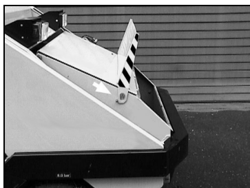
Behälterauswurfklappe muß einrasten.
