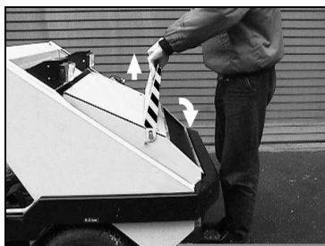
Behälterauswurfklappe anheben und schließen
