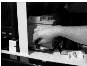
Batteriholderen afmonteres Tag batteriet ud vha. holdeløkkerne
