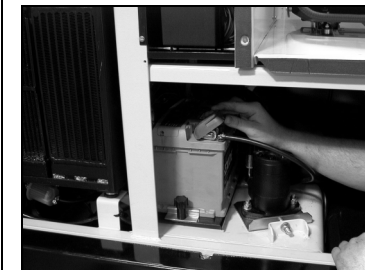
Desserrer la fixation de câble de pôle négatif
