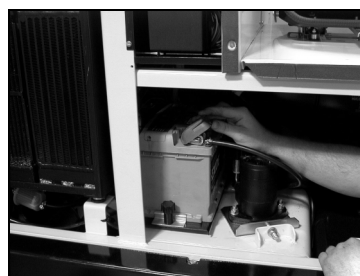
Løsne fastspenning for minuspol-ledning
