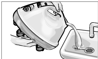
Abb. 4: Reinigung des Kessels
