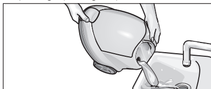
Fig. 13 : rinçage de la chaudière
