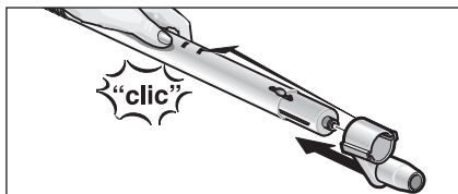
Fig. 4: Påsætning af låsekrogen
