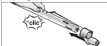
Fig. 4: Segurar o gancho de estacionar
