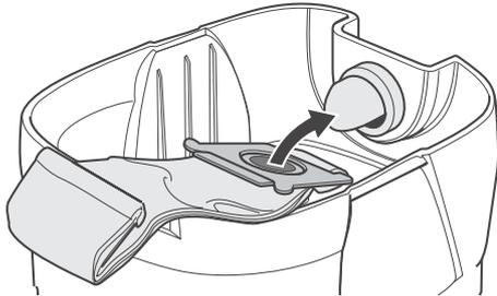
**!** 本体の装着口と紙パックのゴムパッキンが密着していないとゴミがこぼれ落ちますので、しっかりと取付けてください。
