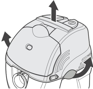
②ごみコンテナの中からキャスター（2個）と後輪（2個）を取出し、取付けます。
