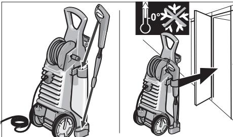
**Pozor!** Neúplně vyprázdněný přístroj může mráz poškodit. Přes zimu skladujte přístroj v prostoru chráněném před mrazem.
