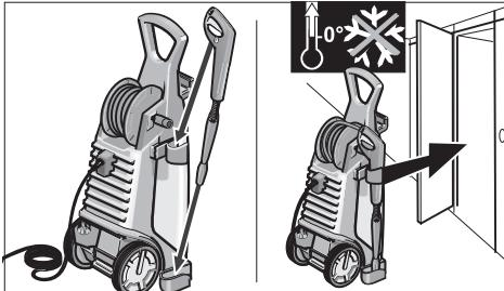
**Uwaga!** Mróz zniszczy urządzenie, jeżeli nie będzie całkowicie opróżnione z wody. Zimą najlepiej przechowywać urządzenie w pomieszczeniu chronionym przed mrozem.
