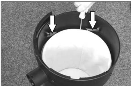
→ Ohišje filtra obrnite in 4 vpenjalne ročice obrnite na stran.
