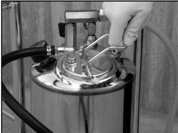
Verschußbügel am Druckbehälter
