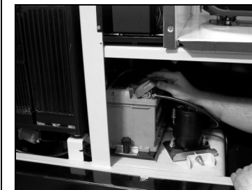
Klemmung für Minuspol-Leitung lösen
