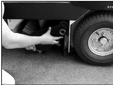
➤ Die Nocken der Schwinge zu den Nuten der Kehrwalze ausrichten und Schwinge aufschieben
