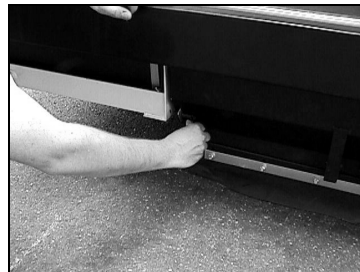
➤ Klappsplint durch die Bohrung stecken und die Ringfeder umklappen
