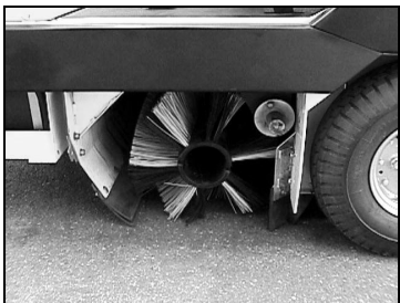
➤ Die Nuten der Kehrwalze müssen auf die Nocken der gegenüberliegenden Schwinge gesteckt werden
