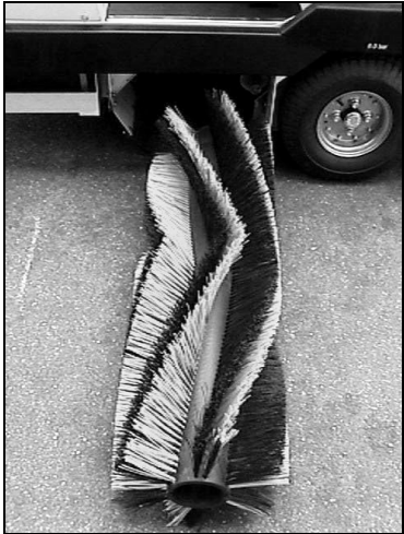
➤ Neue Kehrwalze einbauen
