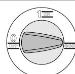
**Indicație:** Utilizând lancea cu reglaj de presiune și selectând poziția de comutator „eco“ puteți economisi apă și curent în proporție de 20 %.
