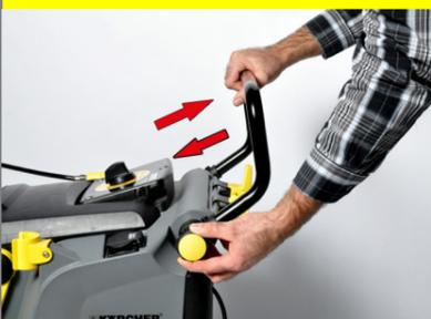
**A** Befestigungsschrauben des Schubügels lösen und Schubügel verstellen.
