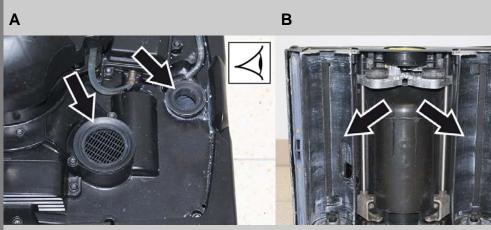
Dichtungen zwischen Gerät und Schmutzwassertank auf Zustand prüfen, bei Bedarf austauschen. Bürstentunnel reinigen.
