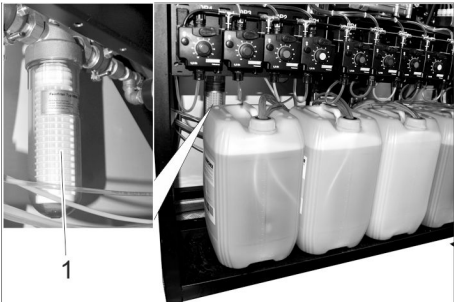
1 Filtro de la bomba de protección antihieladas
