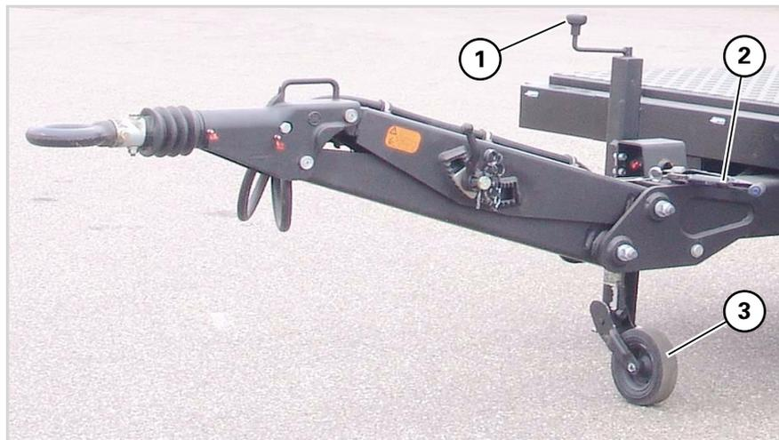
Bild 33 Stützrad und Handbremshebel
