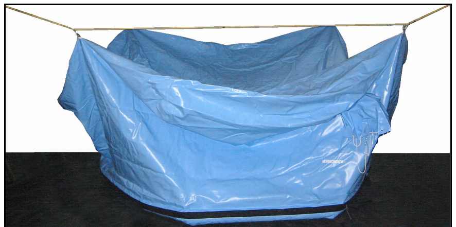
Bild 47 Roh- und Trinkwassertanks trocknen
