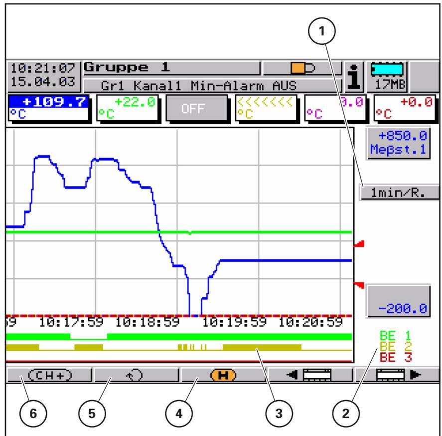
Bild 33 Horizontale Diagrammdarstellung
