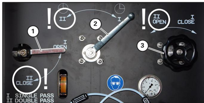
Bild 81 Regelarmatur Double-Pass
