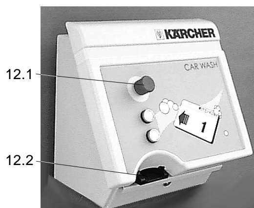
Fig. C.2: Leitor de cartões de lavagem 12.1 Sensor NOT AUS 12.2 Introdução dos cartões de lavagem.
