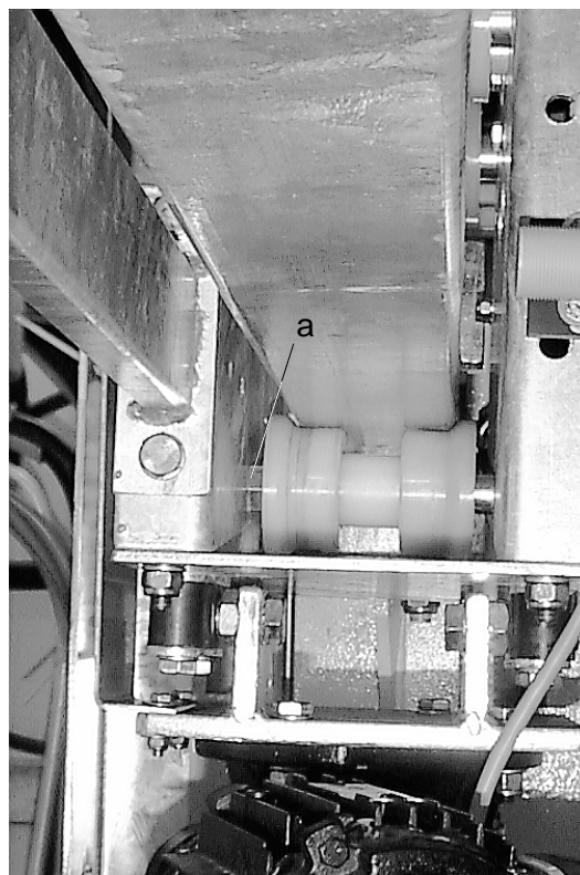
Fig. F.12: Escova lateral a Excêntrico
