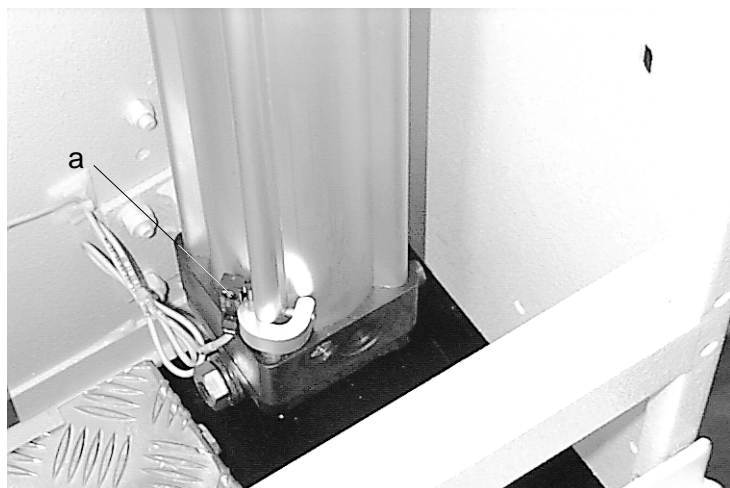
Fig. F.7: Coluna 2 em baixo a Interruptor final escova de tejadilho em cima
