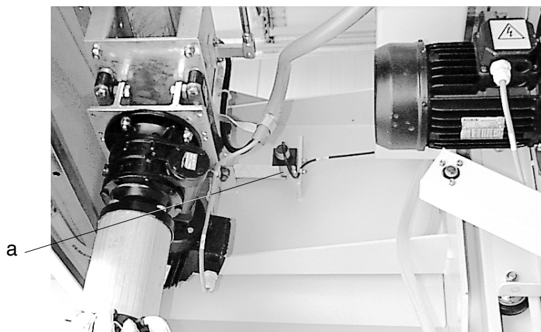
Рисунок F.3: Колонна 1 вверх а Конечный выключатель поворота траверсы боковой щетки
