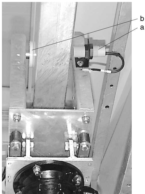
Рисунок F.2: Тележка с боковыми щетками (вид снизу) а Конечный выключатель боковой щетки b Ходовые ролики
