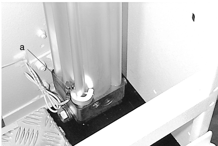
Рисунок F.7: Колонна 2 внизу а Конечный выключатель для потолочной щетки вверх
