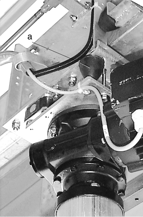
Resim F.16: a Dikey yan fıraların arpma tamponu salınım
