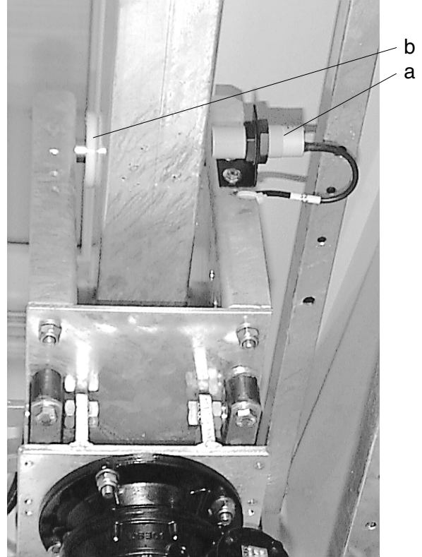
Resim F.2: Yan fırçalar (altdan bakış) a Dikey yan fırça stoperi b Kılavuz teker
