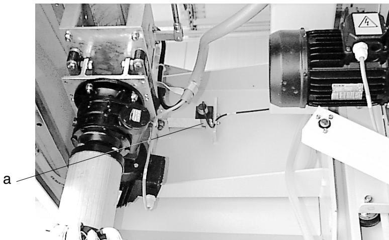
Resim F.3: 1 Nolu kolon üst kısım a Stoper dikey yan fırça traversi
