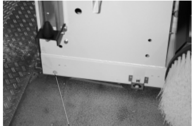
Bild F.13: Hareketli ayaklar a Yağlama nipelini
