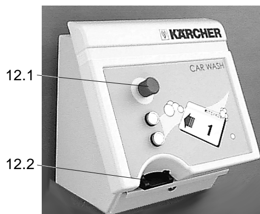
Figura C.2: Lettore carte di lavaggio 12.1 Tasto «ARRESTO D'EMERGENZA» 12.2 Fessura d'introduzione carte di lavaggio
