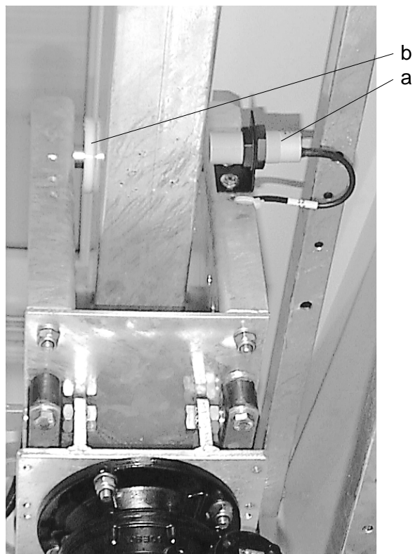
Figura F.2: Carrello spazzola verticale (visto dall'alto) a finecorsa spazzola verticale b ruote di scorrimento
