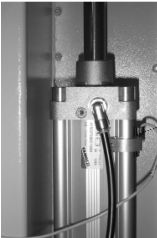
Bild F.8: Säule 2 Mitte a Endschalter Dachbürste unten
