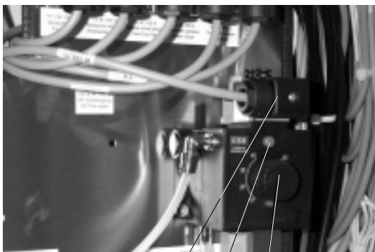
Bild C.4: Dosierpumpen für Reinigungsmittel 6a Drehknopf 6b Pneumatikventil 6d manueller Betätigungstaster
