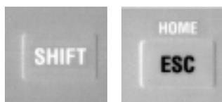
Con la funzione «HOME», da qualsiasi menu si salta direttamente nel menu principale. La funzione «HOME» viene richiamata premendo contemporaneamente «SHIFT» ed «ESC».
