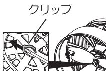
黄色のクリップを矢印の方向に引き抜きます。
