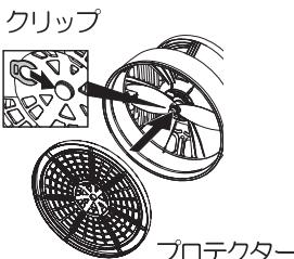
プロテクターを矢印の方向に差し込み取り付けます。
