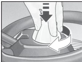
本体のつまみを押しながら回し、本体のノズルの高さを調節してください。
